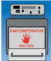
Die Muffel bei Endtemperatur (max. 950°C) im Ofen stehen lassen, je nach verwendeter Größe:
