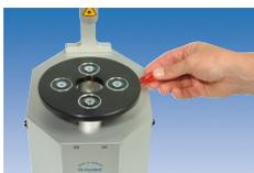
I. Regolazione della profondità di foratura: una volta sostituita la fresa, inserire il cacciavite nel mandrino porta-punta, quindi ruotare verso destra la vite senza testa sulla quale poggia la fresa (il foro trapanato diviene in tal modo più piccolo per cui il perno non poggia più in profondità nella piastra per zoccolo)
