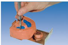
7. Avvitare le piastre magnetiche di fermo mediante la chiave esagonale
