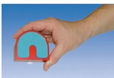
F. Applicare sullo stampo per duplicazione riempito la piastra per zoccolo con i perni in alluminio inseriti e avvitare (non lasciare i perni in alluminio nella massa refrattaria durante la cottura)
